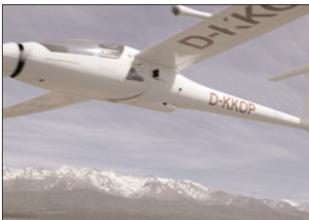
Forschungs-Motorsegler Stemme S 10 mit Spezialsonde zur Böenvermessung im Ausleger vor der Flügelnahe
